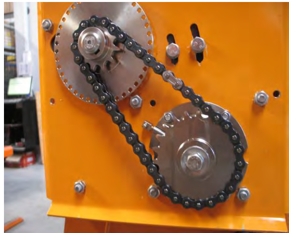
Seitliche Blechdeckel, Kette und Kettenrad demontieren um antriebsseitige Lager zu Wechsln.
