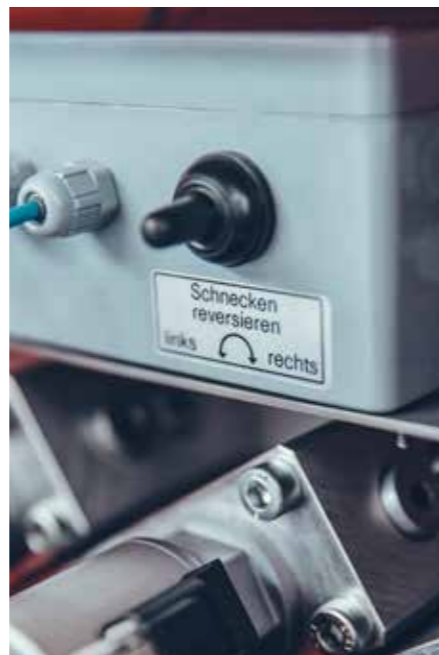
En bas à gauche: bloc de commande hydraulique Kugelmann En bas au milieu: pompe à saumure En bas à droite: inversion de sens de rotation des vis
