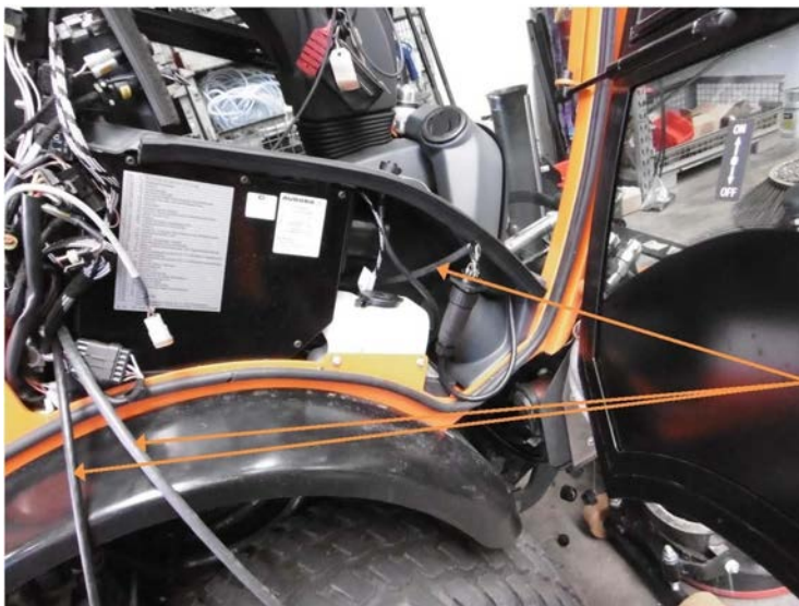
Steuerungs-, Batterie- und Monitorkabel durch den Klimaschacht hinter die Fahrerkabine legen. Rechte Kabinentüre schließen.
