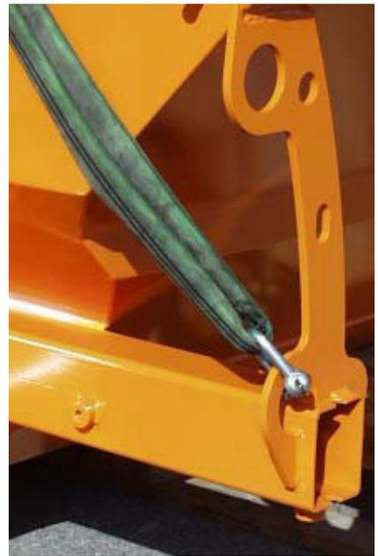
Le centre de gravité de la saleuse est situé derrière le centre du réservoir - vue en direction de marche. Dans cette position, la saleuse peut être enlevée à l'horizontale.
