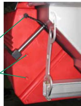
Fermer la soupape d'arrêt à la tubulure de remplissage.
