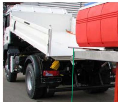
Déplacer le véhicule en ligne droite et centré au-dessous la saleuse jusqu'à ce que les indicateurs latéraux se replient. L'arête arrière du pont basculant ne doit pas toucher les supports.
