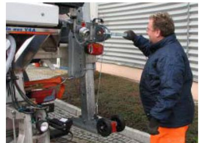
Sécuriser les jambes de support relevées avec les deux goupilles de sécurité. Sécuriser les goupilles de blocage avec les goupilles de sécurité respectives.
