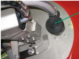
En cas du réglage coaxial de saumure, le clapet de retenue est situé à l'unité de disque. Veuillez ne pas serrer le couvercle avec une clé - seulement avec la main.
