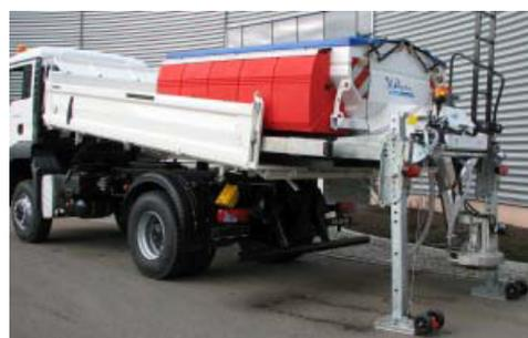
Soulever légèrement le pont basculant, les jambes de support restent fermement sur le sol. Sortir lentement jusqu'à ce que les supports soient complètement rabattus. Les indicateurs latéraux deviennent visibles.
